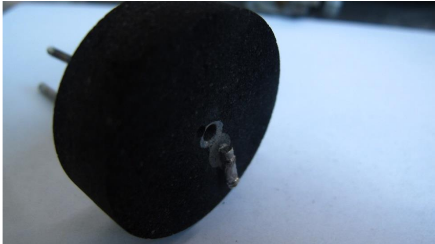
Figura 4.26. Imagen del tungsteno fundido en el grafito.
