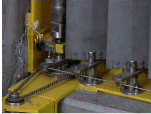
Figura 2.7. Imagen del mecanismo de movimiento de las persianas del atenuador
