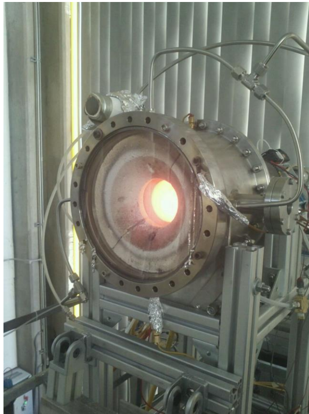
Figura 4.25. Imagen del reactor con el grafito emitiendo energía térmica después de haber cerrado las persianas del atenuador.
