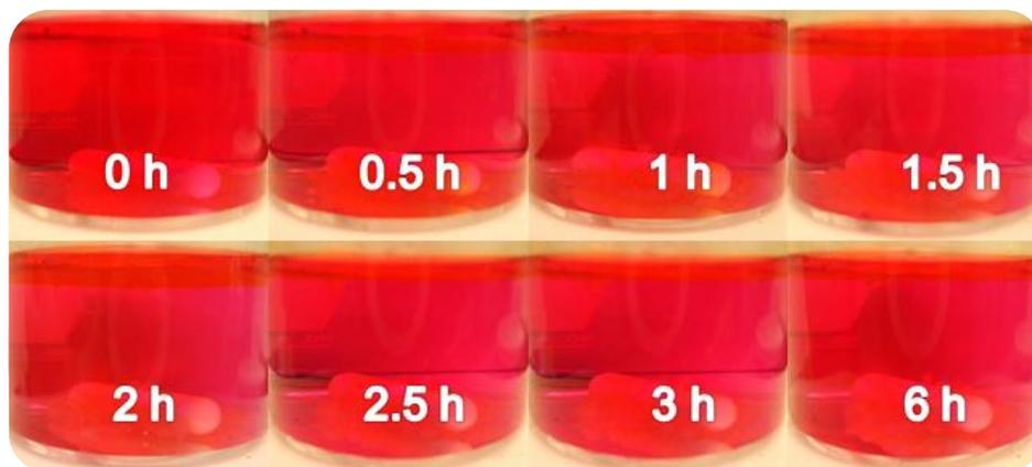
**Figura 67.** Decoloración de la solución de rojo de metilo 10 mg/L utilizando las esferas de quitosán 3.0% a diferentes tiempos de contacto en el 5° ciclo de adsorción-regeneración.
