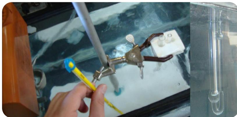
**Figura 25.** Determinación del peso molecular promedio del quitosán por viscosimetría capilar.
