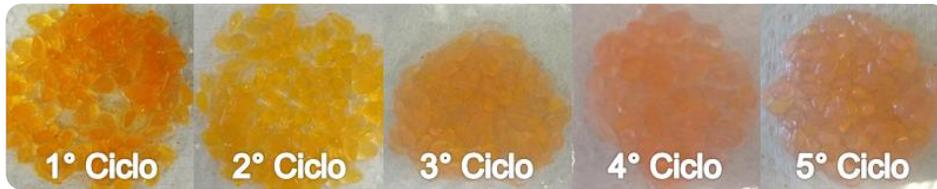
**Figura 62.** Esferas de quitosán 3.0% después de haber sido expuestas con la solución de rojo de metilo 10 mg/L a los diferentes ciclos de adsorción-regeneración.
