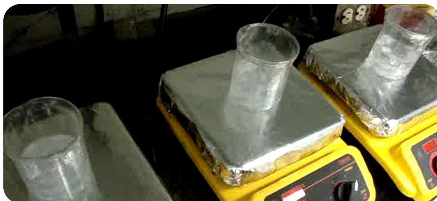
**Figura 35.** Esferas de quitosán y quitosán-TiO<sub>2</sub> en contacto con la solución del ion de Cu(II) 5 mg/L.
