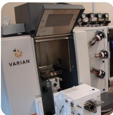
Figura 34. Espectrómetro de Absorción Atómica.
