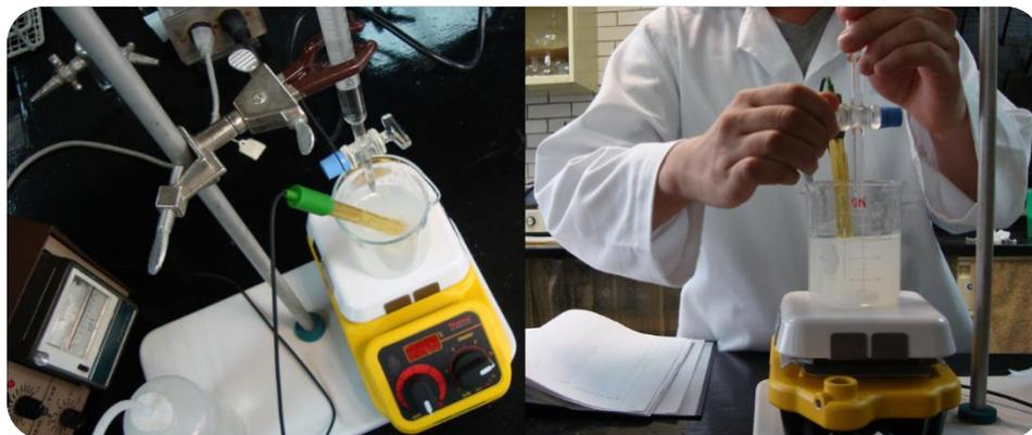
**Figura 24.** Determinación del grado de desacetilación del quitosán por titulación potenciométrica.
