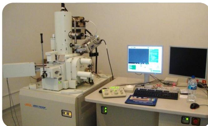
**Figura 39.** Microscopio Electrónico de Barrido de Emisión de Campo.
