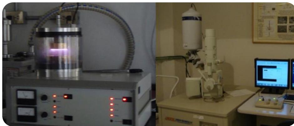
**Figura 26.** Evaporadora de oro-plasma (izquierda) y Microscopio Electrónico de Barrido (derecha).
