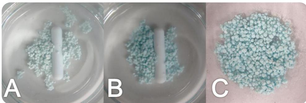
**Figura 53.** Esferas de quitosán 2.0%-TiO<sub>2</sub> 0.8% al tiempo de A) 0 h, B) 4 h y C) 4 h (filtradas), en contacto con la solución de Cu(II) 100 mg/L.
