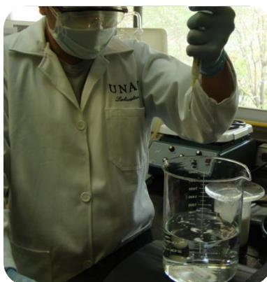
**Figura 31.** Síntesis de las esferas de quitosán-TiO<sub>2</sub> impresas molecularmente.
