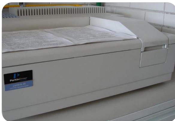
Figura 37. Espectrómetro UV-Visible de doble haz.
