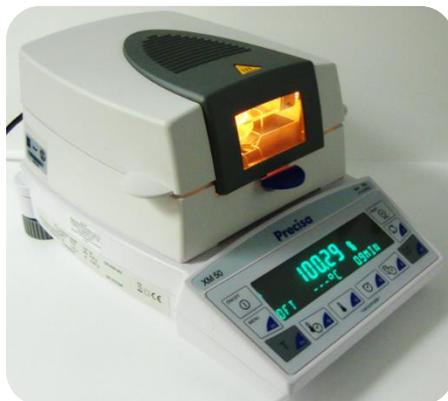
**Figura 32.** Medición de la masa de las diferentes esferas de quitosán y quitosán-TiO<sub>2</sub> húmedas después de haber sido hidratadas empleando una termobalanza.
