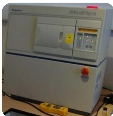
Figura 27. Difractómetro de Rayos X.
