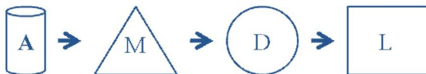
**Figura 20.** Esquema general de un espectrómetro de emisión atómica: A, atomizador/ionizador; M, monocromador de gran resolución; D, detector multiseñal; y L, dispositivo de lectura.
