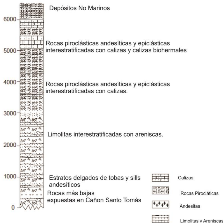
Figura 4-1. Columna estratigráfica generalizada para la Formación Alisitos en el área de Punta China. (Modificada de Allison, 1974)
