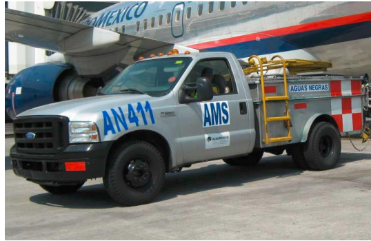
Imagen 53. Camioneta de Aguas Negras
