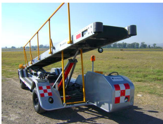
Imagen 56. Banda Conveyor o Rampa Eléctrica
