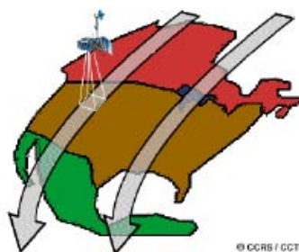
Fig. 26 Ancho de barrido [6]
