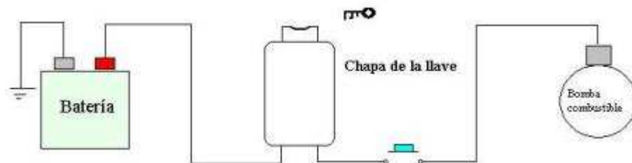
FIGURA 1.21 INSTALACIÓN DE CORTA CORRIENTE
