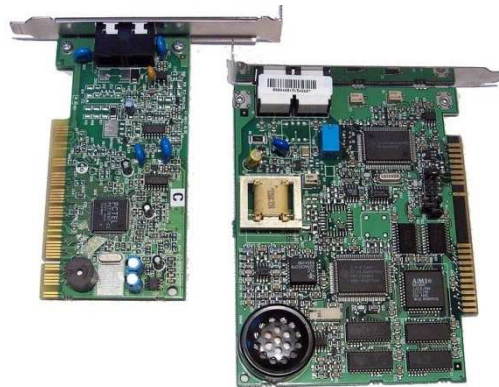
FIGURA 2.0 MÓDEM POR SOFTWARE PCI (IZQUIERDA) Y MÓDEM HARDWARE ISA (DERECHA).
