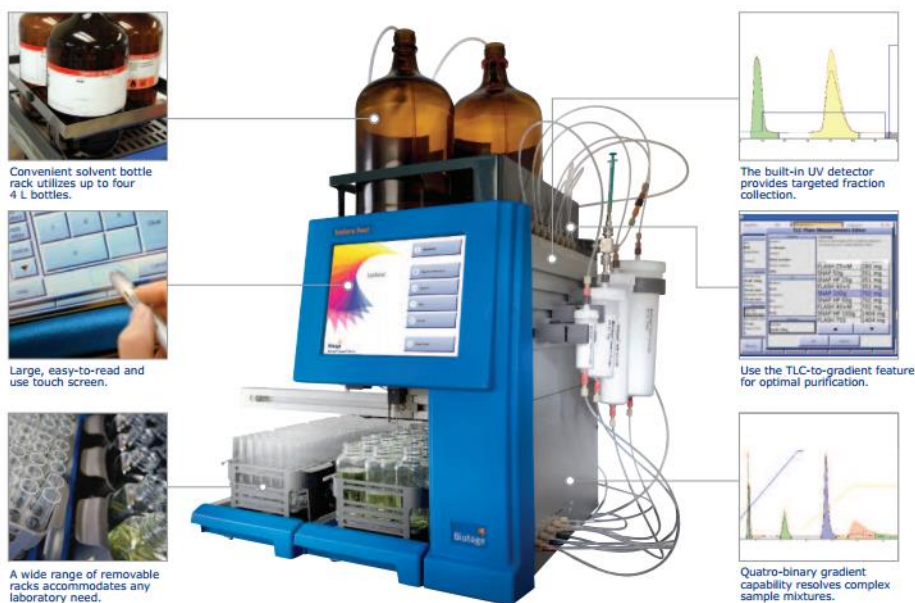
Figura 10. Sistema Isolera™ ONE para cromatografía flash. El sistema cuenta con una bomba que suministra los solventes de acuerdo a la proporción indicada, cartuchos con sílice en los que se coloca la muestra, y un software que arroja los resultados en un cromatograma.
