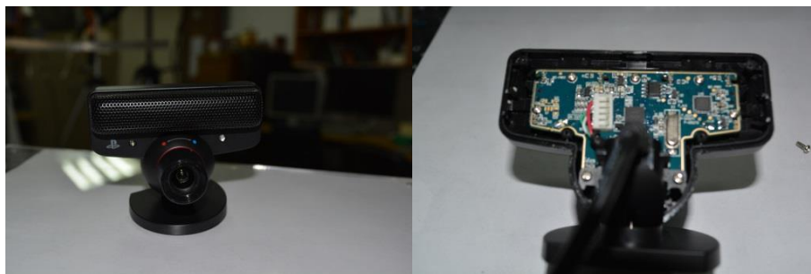
Figura 3.1. Desmontaje de la cámara.
