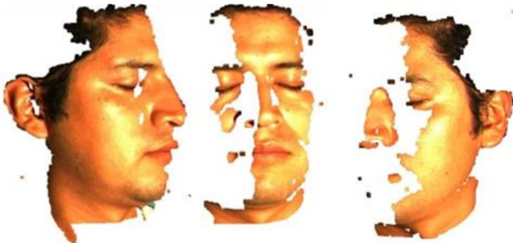
Figura 2.1. Resultado del escáner de luz estructurada, requiere de tres cuadros para representar totalmente la superficie facial. El color amarillo se debe a la iluminación utilizada para la adquisición.
