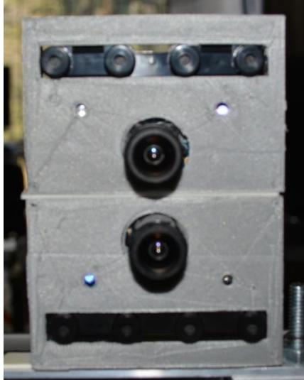
Figura 3.4. Arreglo de cada par de cámaras.
