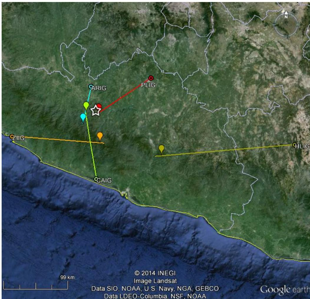
Figura 28. Localización del sismo local 11. En colores se muestran las localizaciones obtenidas de cada estación a través de obtener el acimut inverso de la señal con cada una (ARIG, ZIIG, PNIG, CAIG y HLIIG). La estrella blanca, representa la localización obtenida con SEISAN.
