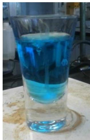
Solución de Cu (II) después de la valoración con EDTA.
