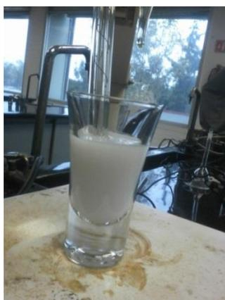
Inicio de la valoración de ácido ascórbico con Cu (II), se observa turbidez en la solución valorada a la primera adición de titulante.
