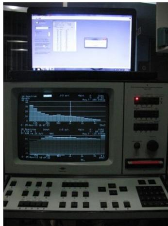
**Figura 1.** Analizador marca B&K modelo 2133 y programa en Labview B&K2133
