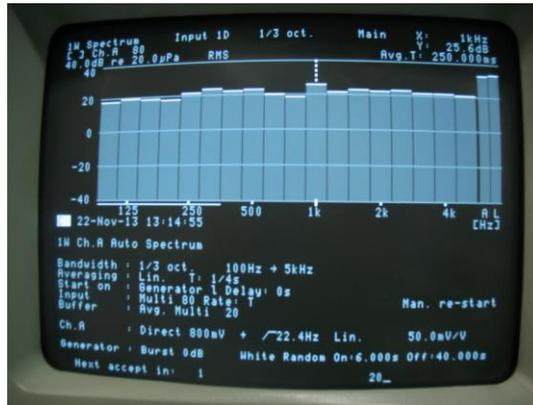
Figura 3. Pantalla de analizador de frecuencia marca B&K modelo 2133
