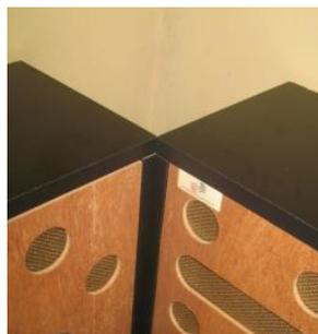
**Figura 2.29.** Cavidad ocasionada en la colocación de 2 muestras por cada esquina.
