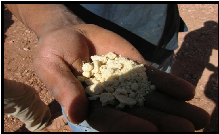
Figura 61.- Agente explosivo hecho a base de nitrato de amonio y diesel, para rellenar los barrenos hechos en la mina El Redentor, comunidad de La Trinidad, San Juan de Rio, Querétaro, México.
