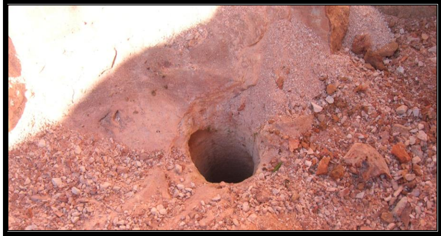
Figura 58.- Diámetro de 1"1/2 hecho en la roca, en el yacimiento de ópalo en la mina El Redentor, comunidad de La Trinidad, San Juan de Rio, Querétaro, México.
