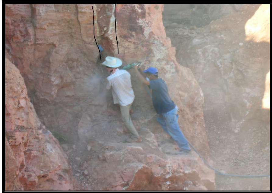
Figura 57.- Barrenado de la cantera siguiendo la veta, marcada con líneas del yacimiento de ópalo en la mina El Redentor, comunidad de La Trinidad, San Juan de Rio, Querétaro, México.
