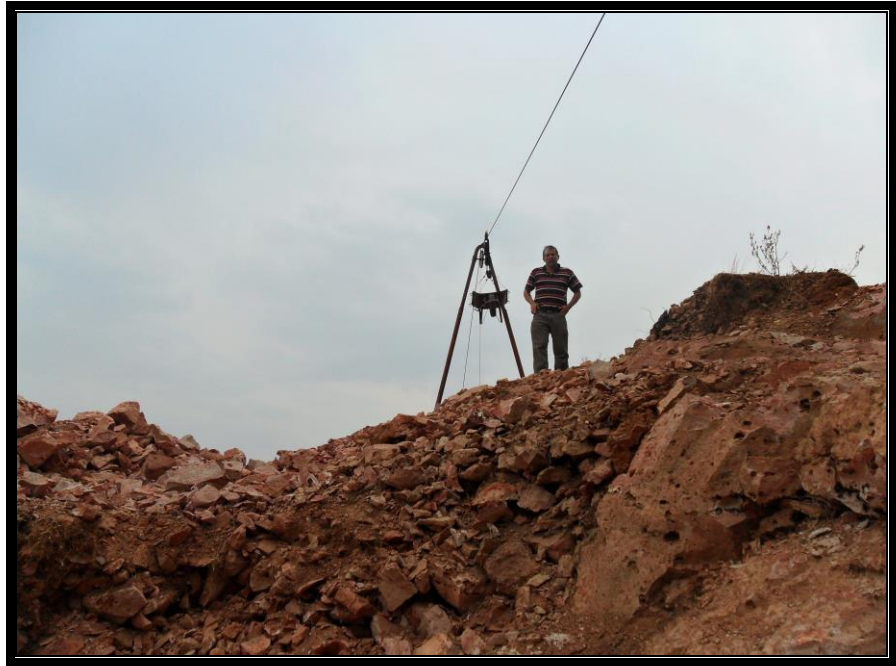
Figura 68.- Zona donde se descarga el material que ya no es redituable, mediante el malacate, en la mina El Redentor, comunidad de La Trinidad, San Juan de Rio, Querétaro, México.
