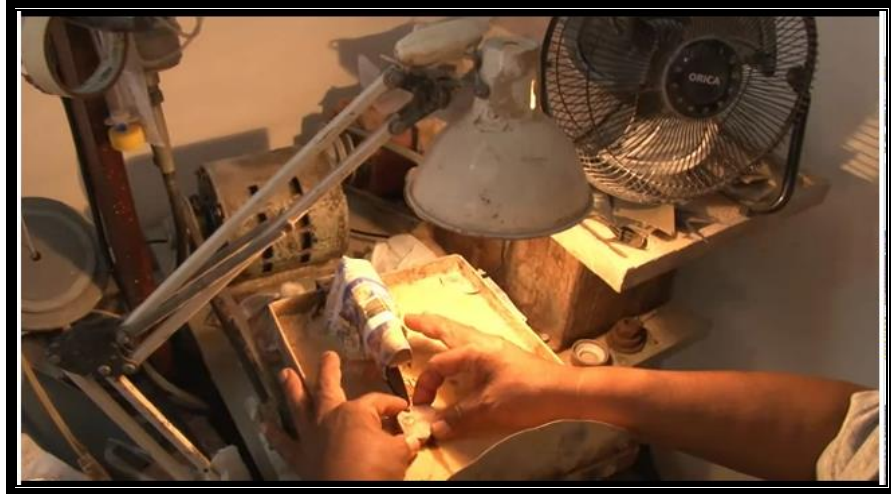
Figura 71.- Disco de diamante usado para cortar el exceso de material, de la roca encajonante en un taller de lapidaria ubicado en la Comunidad de La Trinidad, en el Municipio de San Juan del Rio.
