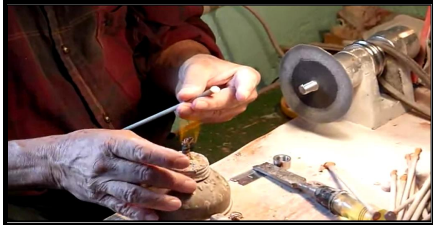
Figura 73.- Varilla con el lacre para pegar el ópalo en un taller de lapidaria ubicado en la Comunidad de La Trinidad, en el Municipio de San Juan del Rio.
