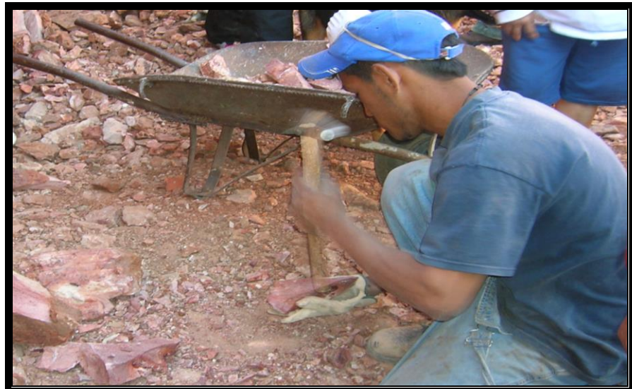
Figura 65.- Mineros haciendo la búsqueda de ópalo. Fragmentan las rocas más grandes, depositan el material sobrante en la carretilla.
