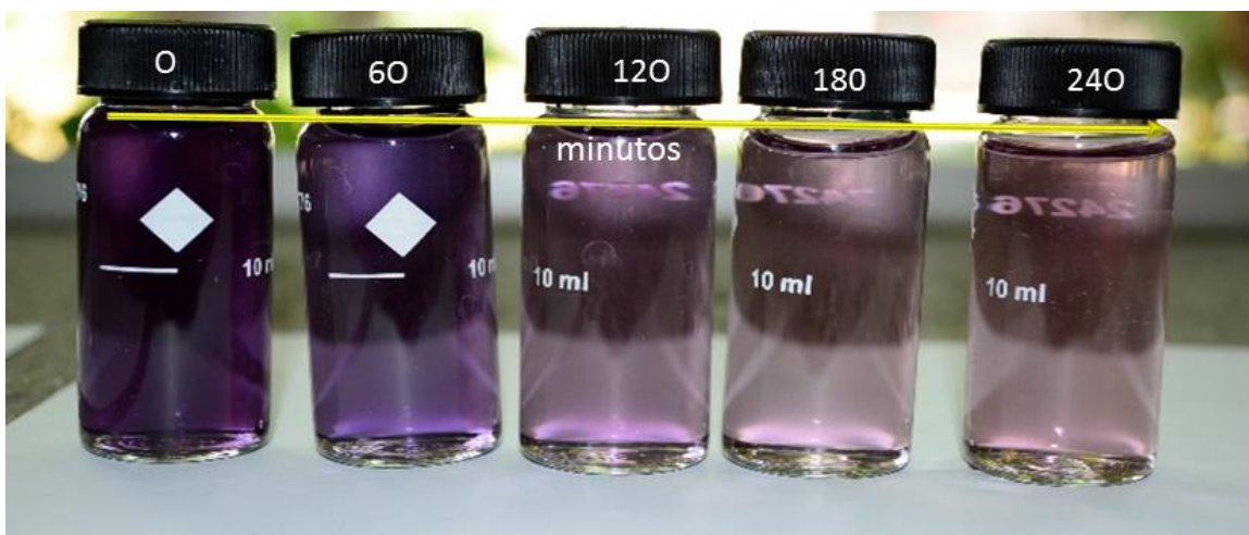
Figura 4.45. Seguimiento visual tomadas a diferentes intervalos de tiempos durante 240 min (Bloque 12) para la decoloración del colorante azul directo 2 con la enzima peroxidasa del residuo industrial de soya se obtuvo un 38.9% de decoloración en 4 h, con 37.5°C, con una concentración de enzima de 1500 \mu L y de peróxido de 1500 \mu L, a pH de 5.5 con una concentración inicial de 35 mg/L de colorante.
