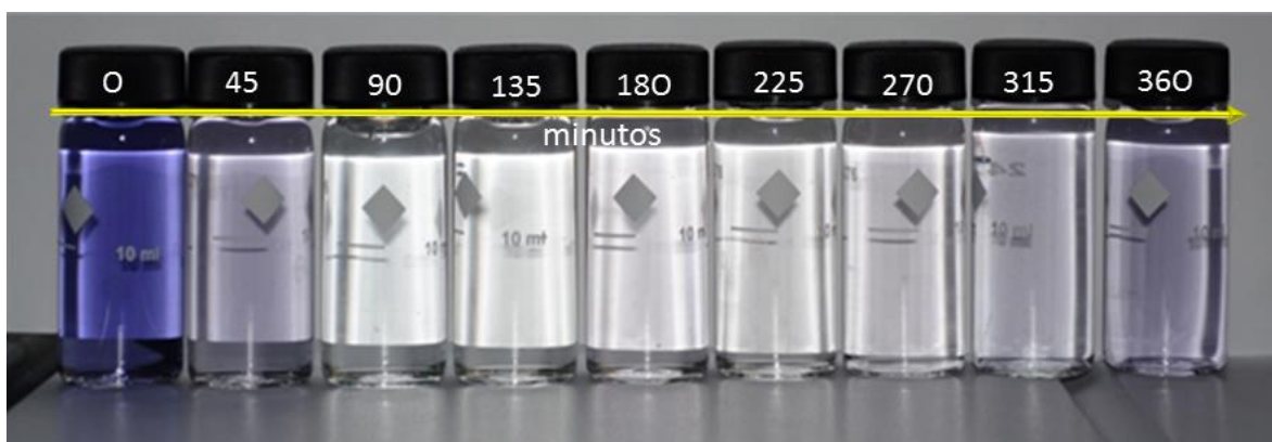
Figura 4.51. Seguimiento visual tomadas a diferentes intervalos de tiempos durante 360 min (Bloque 33) para la decoloración del colorante azul directo 2 con la enzima peroxidasa del residuo industrial del chayote se obtuvo un 89.6% de decoloración en 6 h, con 50°C, con una concentración de enzima de 2000 \mu\text{L} y de peróxido de 2000 \mu\text{L} , a pH de 3.5 con una concentración inicial de 10 mg/L del colorante.
