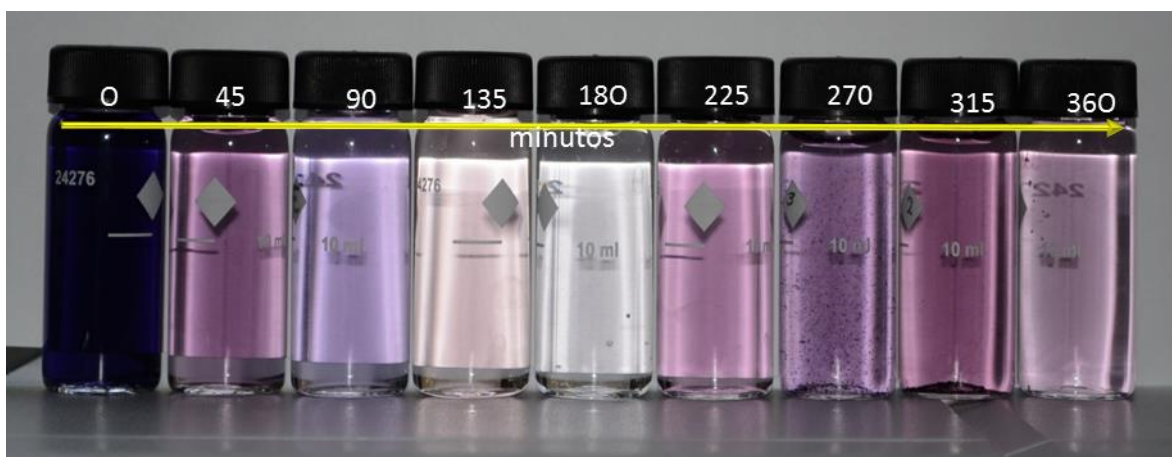
Figura 4.50. Seguimiento visual tomadas a diferentes intervalos de tiempos durante 360 min (Bloque 2) para la decoloración del colorante azul directo 2 con la enzima peroxidasa del residuo industrial de soya se obtuvo un 51.1% de decoloración en 6 h, con 50°C, con una concentración de enzima de 2000 \mu\text{L} y de peróxido de 1000 \mu\text{L} , a pH de 7.5 con una concentración inicial de 60 mg/L del colorante.
