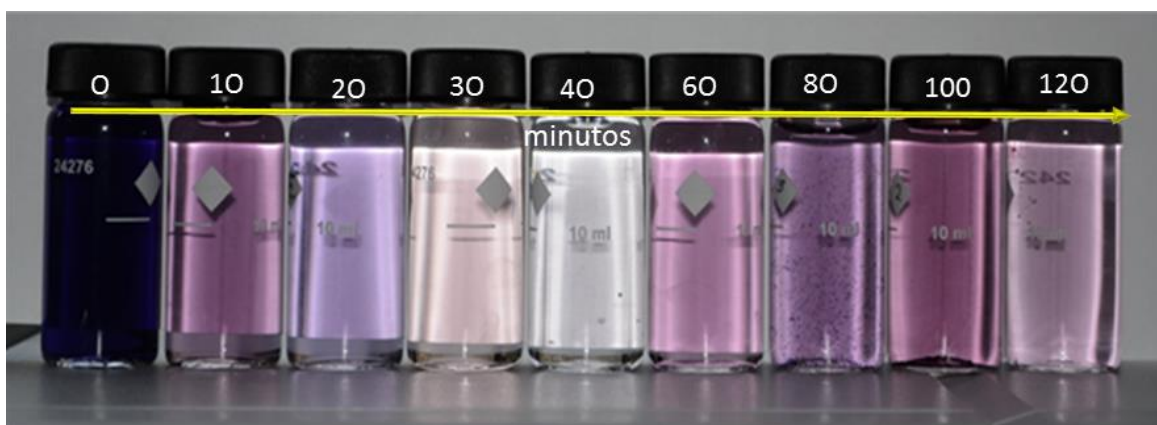
Figura 4.40. Seguimiento visual tomadas a diferentes intervalos de tiempos durante 120 min (Bloque 30) para la decoloración del colorante azul directo 2 con la enzima peroxidasa del residuo industrial de soja en donde se obtuvo un 51.7% de decoloración en 2 h, con 50°C, con una concentración de enzima de 1000 \mu\text{L} y de peróxido de 2000 \mu\text{L} , a pH de 3.5 con una concentración inicial de 60 mg/L de colorante.
