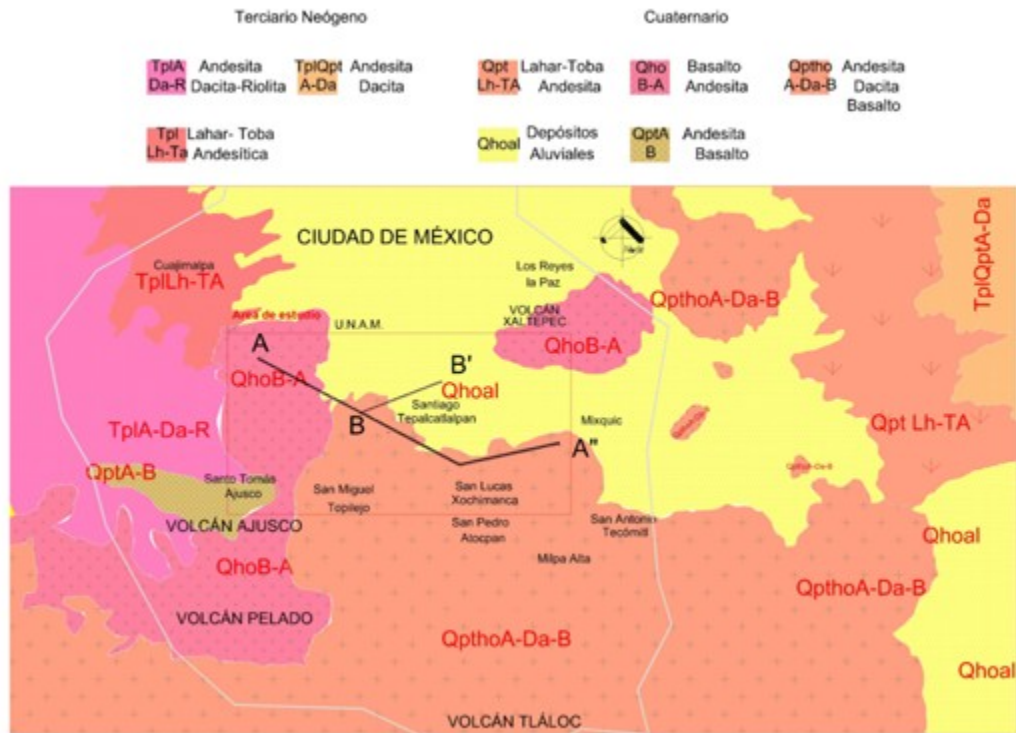
Figura 1-2. Geología de la zona (adaptado de la Carta Geológica Minera E 14-2 Ciudad de México del Servicio Geológico Mexicano) y localización de las secciones A-A" y B-B'.
