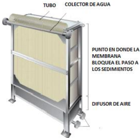
ILUSTRACIÓN 24. BIORREACTOR DE MEMBRANA
