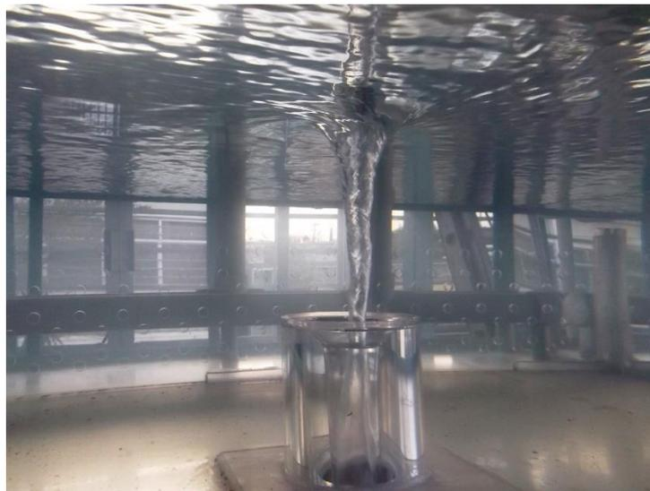
Ilustración 5.12 Vórtice completamente desarrollado
