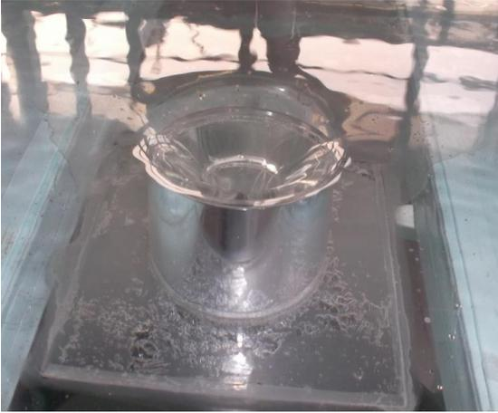
Ilustración 5.9 Descarga con flujo a superficie libre
