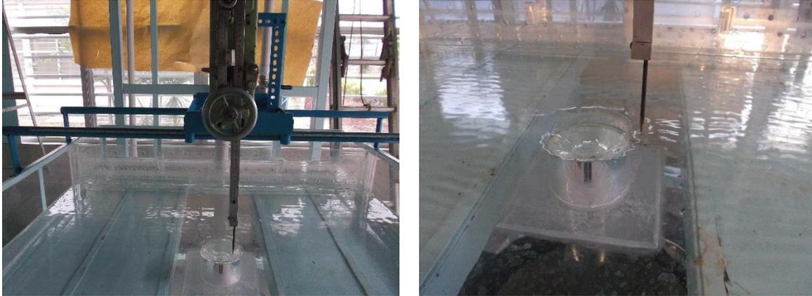
Ilustración 5.21 Medición del perfil de flujo sobre la cresta del vertedor
