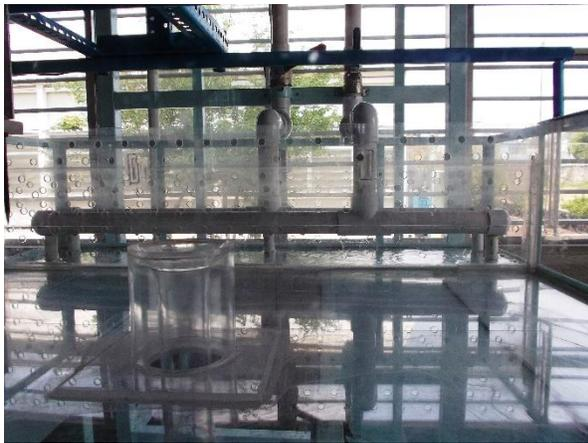
Ilustración 5.13 Tranquilizador con flujo desbalanceado
