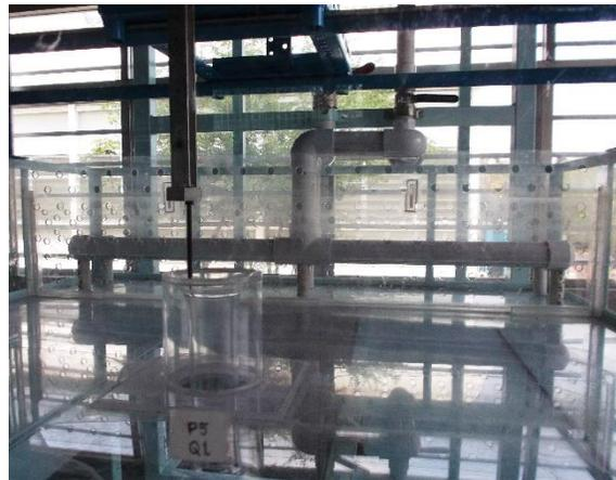
Ilustración 5.14 Corrección de tranquilizador (flujo balanceado)
