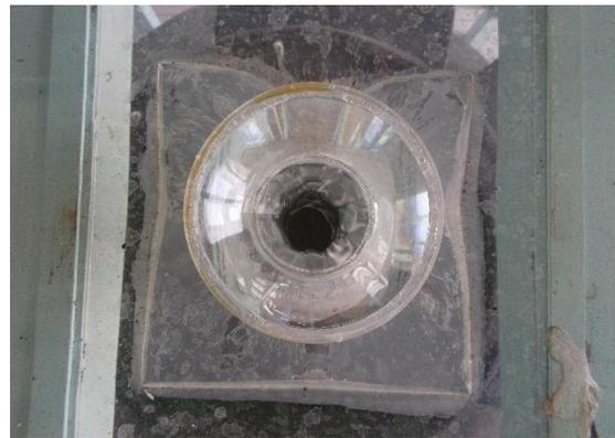
Ilustración 5.23 Flujo en gasto máximo seleccionado  $Q = 1.26$  l/s.
