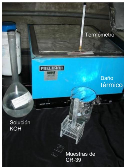
Figura 3.7. Instrumentos utilizados para realizar el grabado químico del CR-39 en el Instituto de Física, UNAM.
