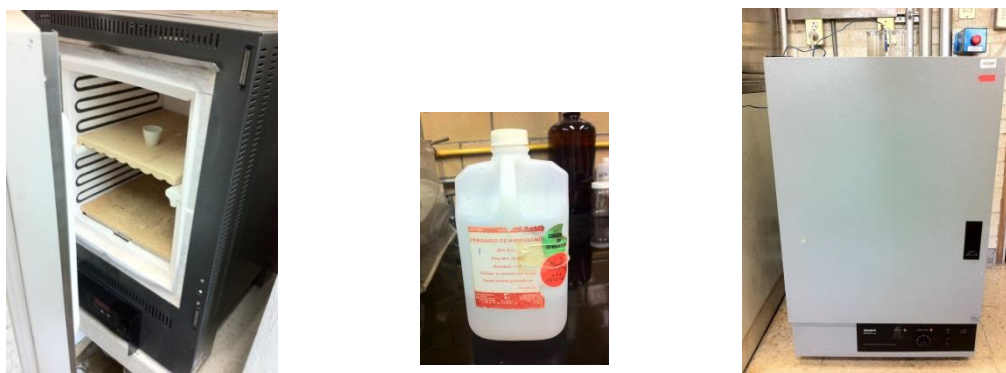
Figura V.4. Basalto en crisol dentro de la mufla, peróxido de hidrógeno, horno a 105 °C.
