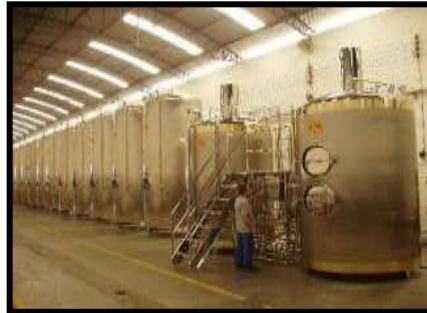
Fig. 56 Uni- Tank de Maduración (Química Industrial INEM)
