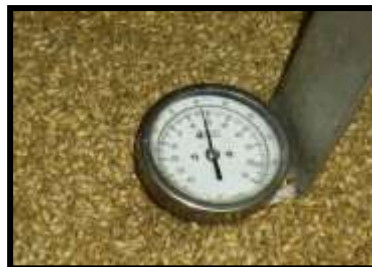
Fig. 49 Control de Temperatura durante el remojo de la cebada (Proceso de la Malta, 2008)
