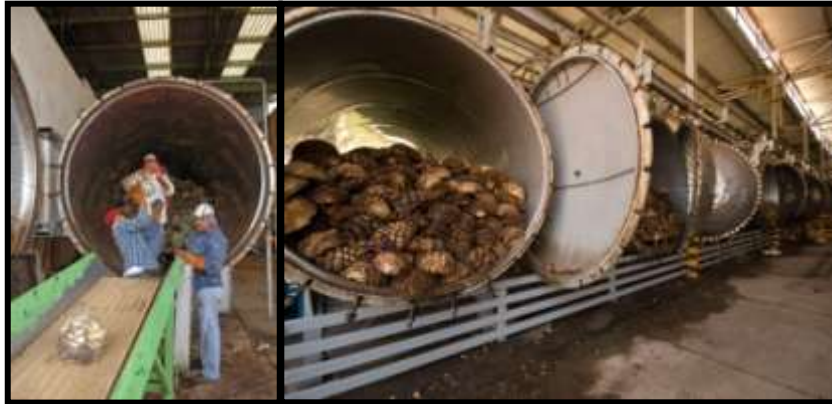
Fig. 101 Cocción de Agave en Autoclave (Tequila Sauce.com, 2013)
