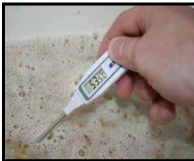
Fig. 53 Verificación Manual de Temperatura mediante la Maceración (Revista Mash. Ciencia Cervecera, 2009)
