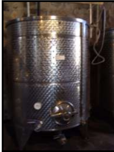
Fig. 34 Fermentación en tanques de acero inoxidable (Meme, Vino y Arte Culinario, 2009)
