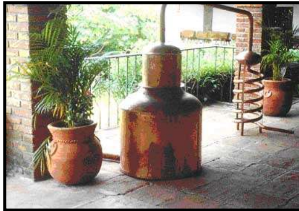
Fig. 74 Campana y serpentín del alambique (Ramales Osorio Martín C., Ortiz Bravo Eric G., 2006)
