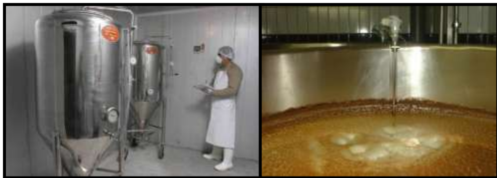
Fig. 55 Fermentadores de Cerveza (Equipos para micro cervecerías y negocios, 2014)
