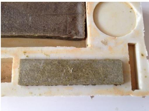
Fig. 40: Comparativo de encogimiento con respecto al molde entre el material 1 (pieza superior) y el material 2 (pieza inferior)
