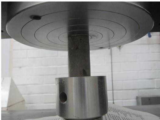
Fig. 42: Prueba de resistencia a la compresión  $M1^{205}$
