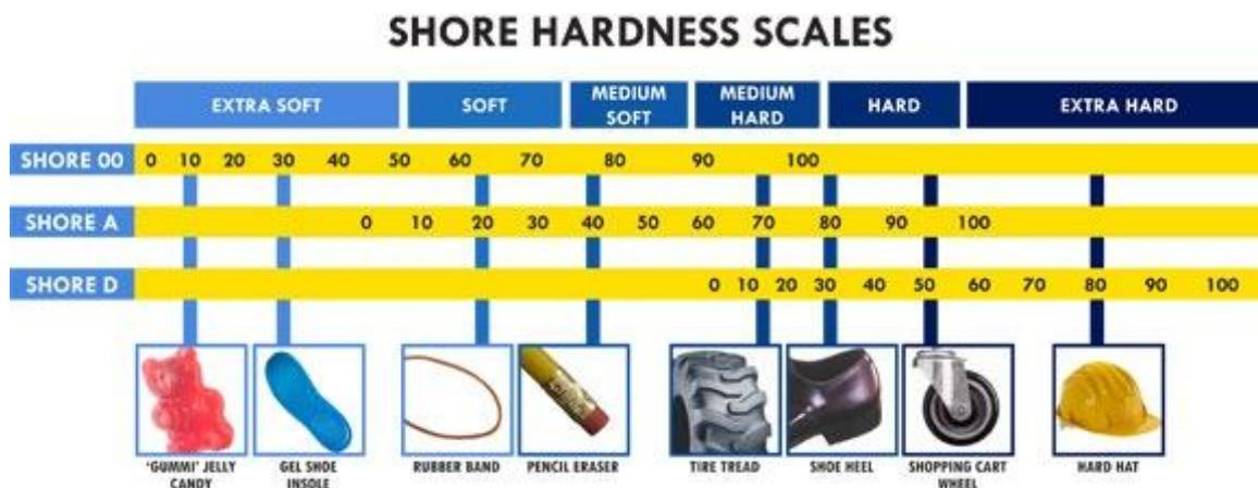
Fig. 50: Escala de dureza Shore
