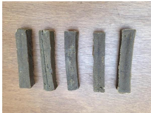
Fig. 38: *Las probetas presentan cierta deformación al secar*
