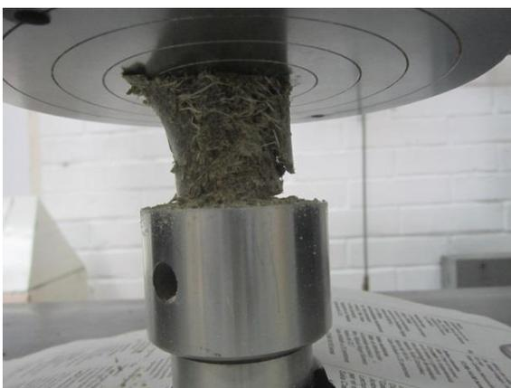
Fig. 45: Prueba de resistencia a la presión  $Mz^{206}$
