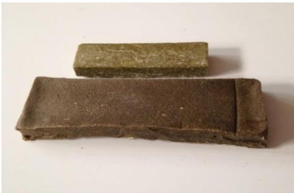
Fig. 36: *Se cortará el exceso de material (pieza de la izquierda) para alcanzar el tamaño especificado (pieza de la derecha)*
