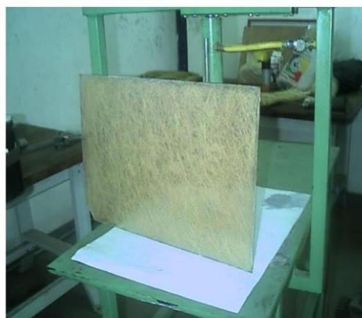
Fig. 15: Material compuesto con arreglo al azar de fibras<sup>106</sup>
