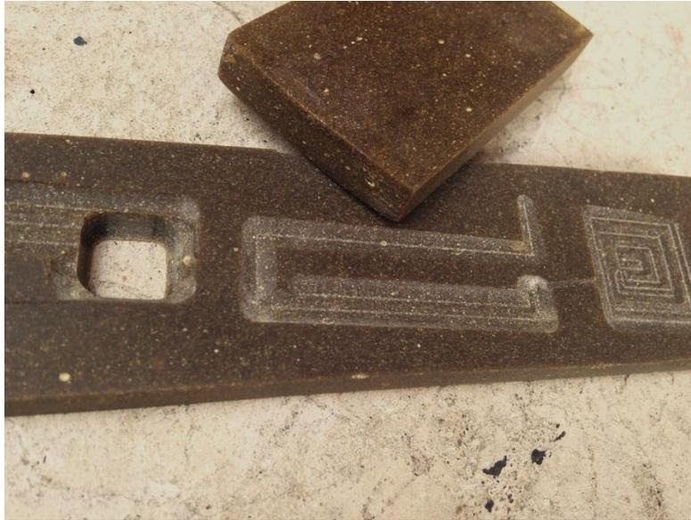
Fig 51: Buena capacidad de maquinado de material 1 en router CNC
