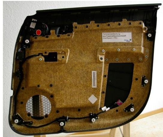
Fig. 5: Material biocompuesto utilizado en la industria automotriz
