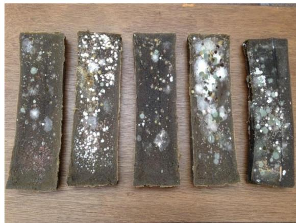
Fig. 39: *Las probetas de llenaron de moho al secar en un lugar encerrado, frío y húmedo*
