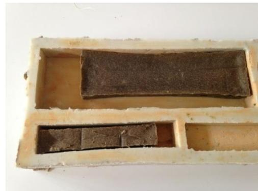
Fig. 35: Comparación entre las dimensiones finales de las piezas con respecto al molde después de su secado
