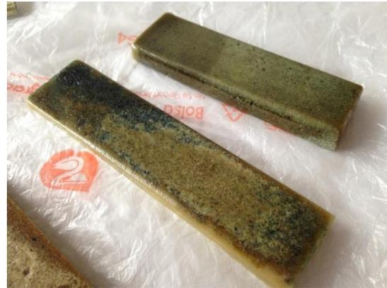
Fig. 61: Pruebas en material 2 que simulan acabados cerámicos
