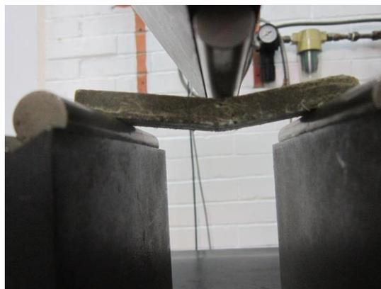
Fig. 46: Prueba de resistencia a la flexión
