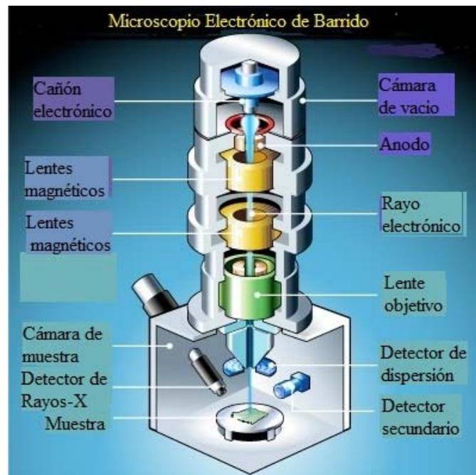
Fig. 2.3 Esquema y sus componentes del microscopio electrónico de barrido.
