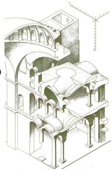
Fig. 47 Corte de vista interior Santa Sofía (tirantes)
