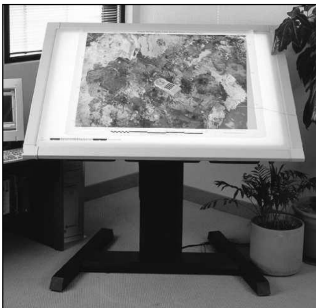
Figura 3.12. Tableta que se utilizó durante el proceso de digitalización de los mapas del Capítulo Geográfico.
