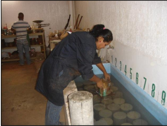
Fotografía 6.19. Inmersión de material después de la prueba Valor Relativo de Soporte (VRS). Fuente: Propia.
