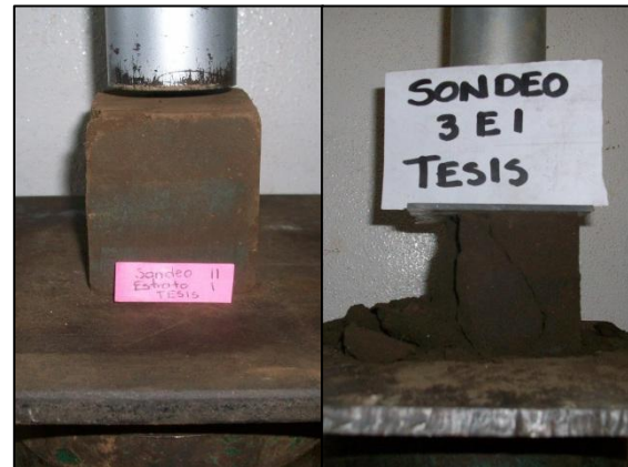
Fotografía 6.22. Colocación y tronado de cubos en la prensa. Fuente: Propia.
