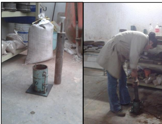
Fotografía 6.11. Equipo y realización de prueba Proctor.
