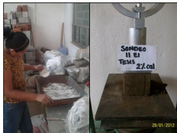
Fotografía 6.24. Suministro del 2% de cal hidratada al material y tronado de cubo ya estabilizado. Fuente: Propia.
