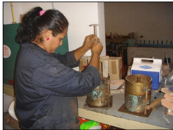
Fotografía 6.18. Determinación de la Expansión del material. Fuente: Propia.
