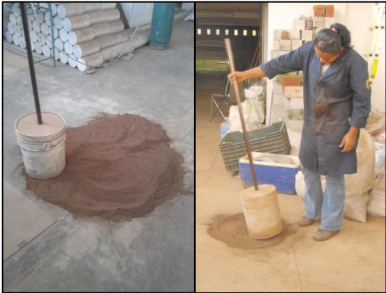
Fotografía 6.9. Disgregación del material muestreado.
