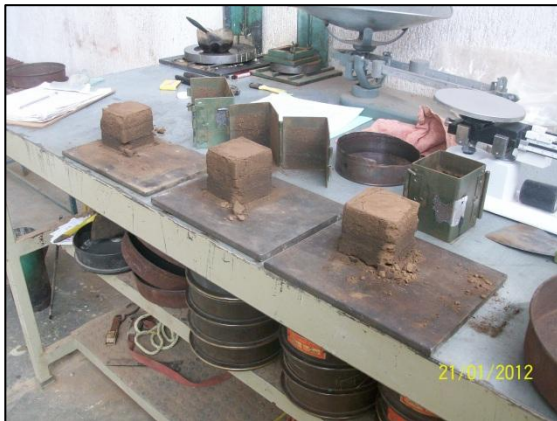
Fotografía 6.21. Desmoldado de cubos de material en condición natural. Fuente: Propia.
