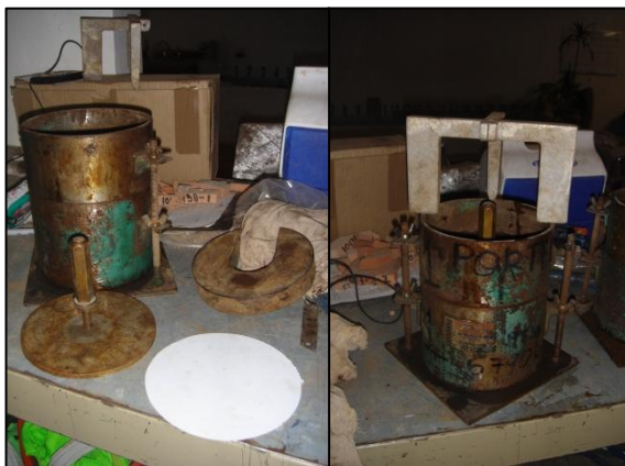
Fotografía 6.17. Colocación de equipo para determinar la Expansión el material. Fuente: Propia.
