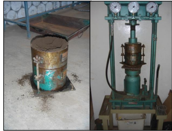
Fotografía 6.14. Colocación de moldes para la realización de Prueba Porter. Fuente: Propia.
