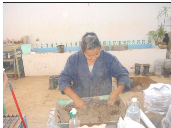
Fotografía 6.12 Distribución de agua al material para proporcionarle la humedad óptima.
