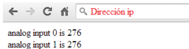
Figura 3.17: Prueba de Arduino funcionando como servidor web.
