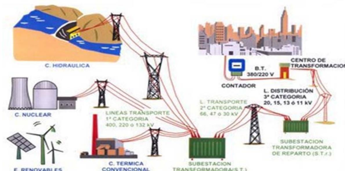
Imagen 1.2 Generación, transporte y distribución de la energía eléctrica.
