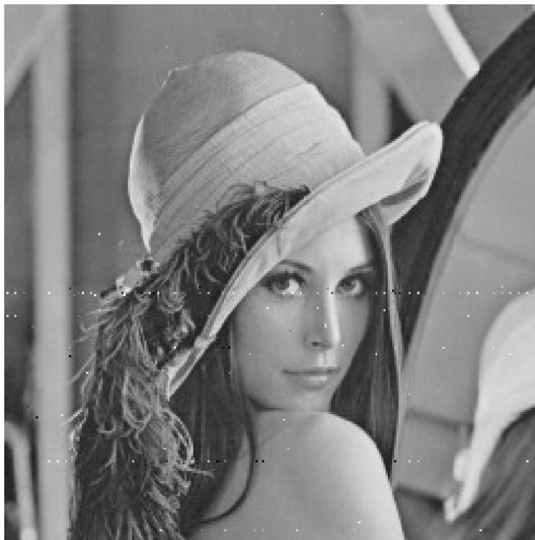
Fig. 5.15 Imagen recibida en el enlace de 40 km. Hay una gran cantidad de errores presente.
