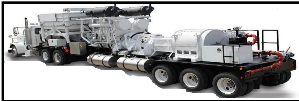
Figura 2.2-D. Unidad de bombeo a alta presión y alto gasto. 9
