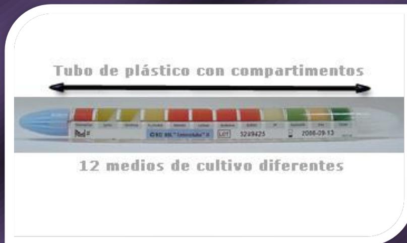
Figura 6.2 Tubo de plástico con compartimentos, formado por 12 medios de cultivo que permiten la determinación de 15 reacciones bioquímicas. Esta concebido para la inoculación simultanea de los 12 medios con una sola colonia.
