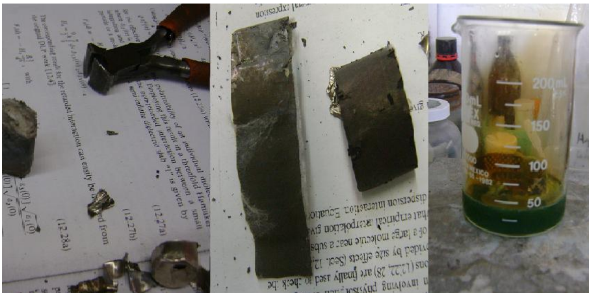
Figura 16. Tratamiento de las baterías.
