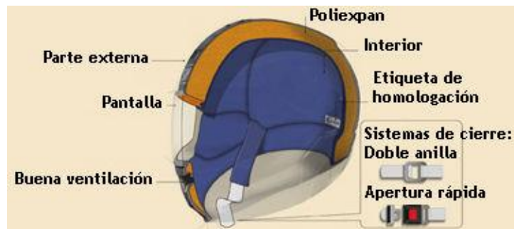
Figura 5: Partes del casco de motocicleta.
