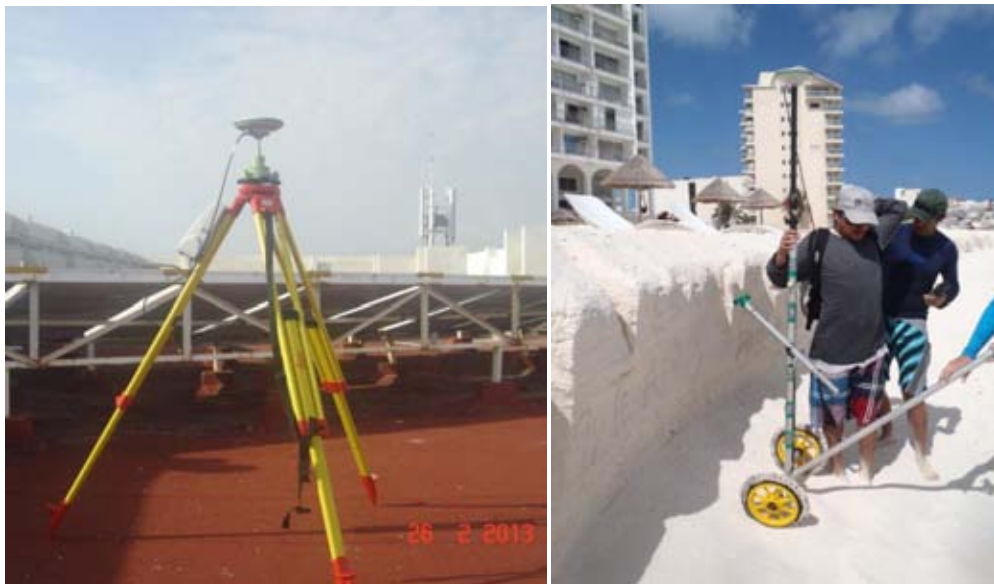
Figura 3. GPS diferencial Base instalado en el techo de un hotel y GPS móvil utilizados en la medición de perfiles de playa.
