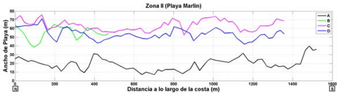
Figura 18. Ancho de playa desde el Norte (0 en el eje X) en la Zona II para cada campaña de medición: A (2009 06 08), antes del relleno y B (2009 12 08), C (2010 03 24) y D (2010 06 08) posteriores al relleno de playa.
