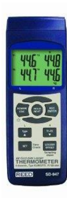
Imagen 24. SD Card Data Logger Thermometer 4ch
