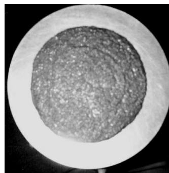
Imagen 22. Consistencia del mortero para ferrocemento. [Bedoya, 1996]
