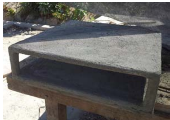
Imagen 7. Panel con Perlita, recién colado.
