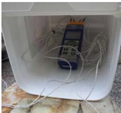
Imagen 4. Protección contra lluvia del aparato de medición
