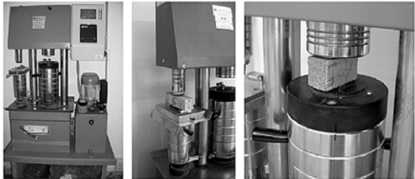
Imagen 2. Izquierda: Prensa para ensayos mecánicos. Centro: Ensayo de flexión. Derecha: Ensayo de compresión
