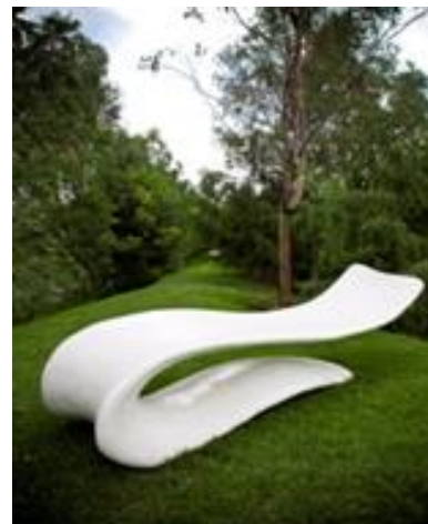
Imagen 16. Ejemplo de utilización del ferrocemento. Banca para jardín que soporta un volado de 1.6 m. Fuente: Javier Senosiain
