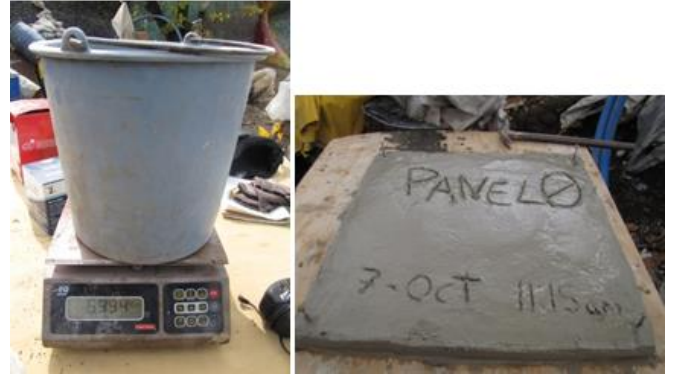
Imagen 13. Izquierda Muestra de cómo se pesó el material para las pruebas. Derecha. Panel 0 recién colado. Se coló sobre un triplay para que durante el fraguado no presentara movimientos que le causaran fisuras. Todos los paneles tienen un grosor que va de 3-4cm
