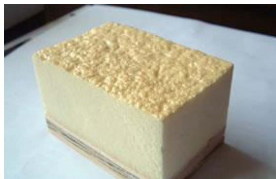
Imagen 29. Muestra de la Espuma de poliuretano expreado a 2" de espesor.
