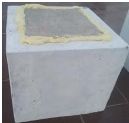
Imagen 10 Panel colocado y sellado sobre el módulo
