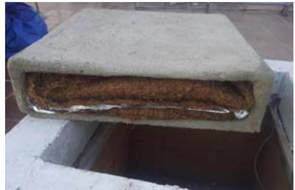
Imagen 8. Panel ya con la fibra de coco en 4 capas y el mylar en medio.
