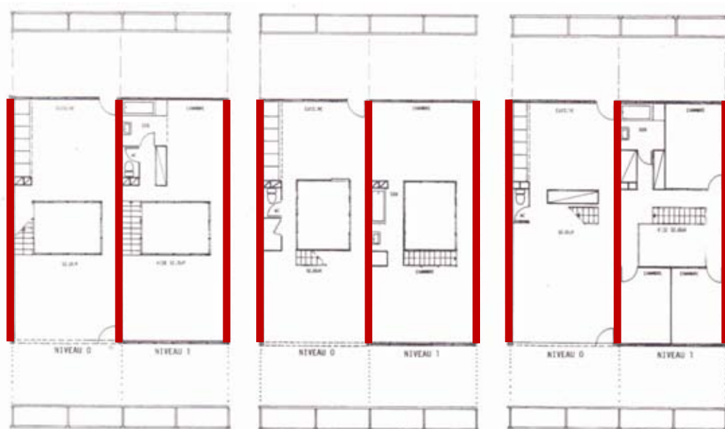
167. La delimitación de los departamentos con muros de carga con claros de 5 metros, permite que el interior pueda ser distribuido de diversas maneras. Departamentos tipo dúplex, Nemausus (1985). Fuente: (Boissière, 1997)
