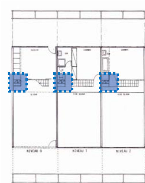
172. Ubicación de instalaciones en ductos registrables colindantes con los núcleos húmedos. Plantas tipo triplex. Nemausus (1985). Fuente: Modificación (Boissière, 1997)
