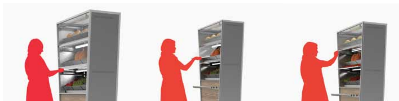
Para abrir los exhibidores, debe tomar la jaladera metálica y levantar la puerta, después deslizarla al interior del mueble.
