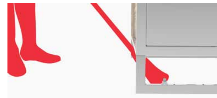
La limpieza del puesto se realiza cómodamente ya que no debe agacharse para pasar la escoba o trapeador.
