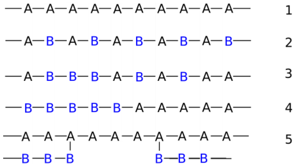
Fig. 1: Representación esquemática del ordenamiento de los monómeros A y B en las distintas posibilidades de copolimerización.
