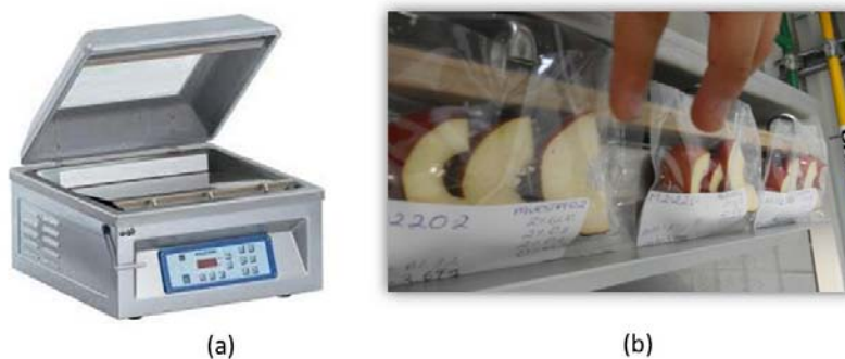
Figura 8. Selladora de vacío. (a) Envasadora Multivac; (b) Acomodo de envases para inyección de aire.
