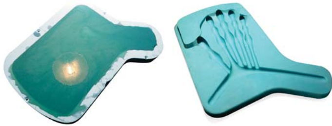
Foto. Vaciado de silicón para molde y molde listo.
