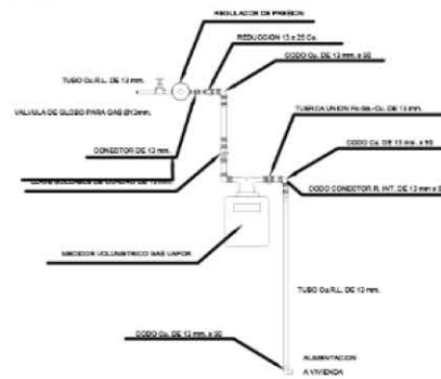
DETALLE DE ALIMENTACIÓN (ACOMETIDA)
