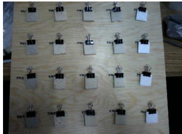
Esponjas para prueba de intemperismo en la zona ajardinada del Conjunto E de la Facultad de Química
