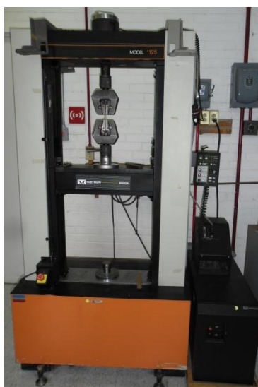
Imagen 4.7. Equipo Instron 5500R, modelo 1125 empleado para caracterizar mecánicamente las esponjas de estudio (operado de conformidad con el manual del equipo)
