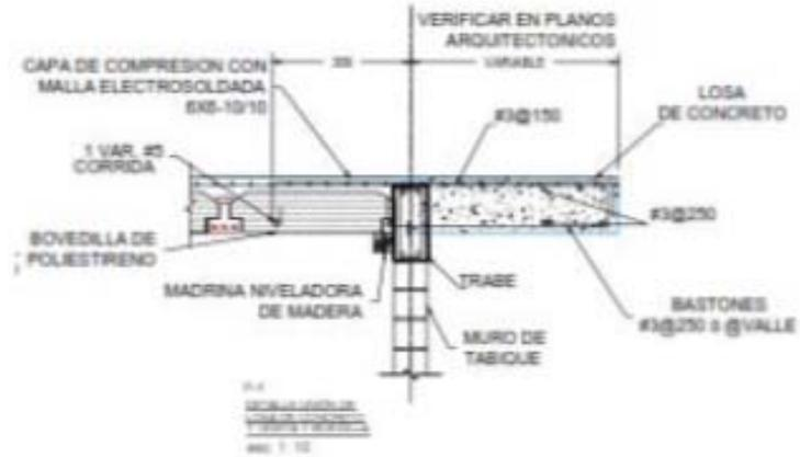
D-3- DETALLE DE LOSA VIGUETA Y BOVEDILLA
