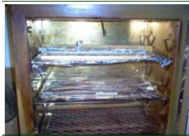
Figura 13. Estufa Kimet para el secado de los núcleos de oyamel extraídos.
