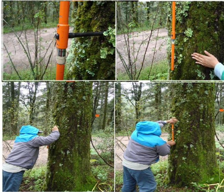
Figura 12. Obtención de los núcleos de crecimiento de las zonas de estudio. Barrenamiento con el taladro Pressler y Extracción del núcleo con el extractor de incrementos.
