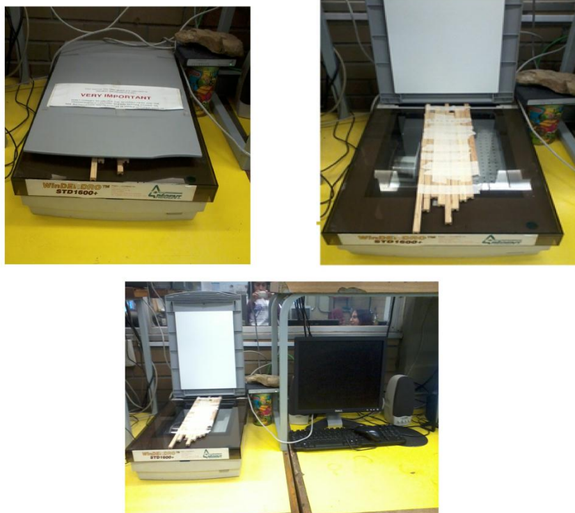
Figura 15. Escáner WinDENDRO con los núcleos extraídos de las zonas de estudio.
