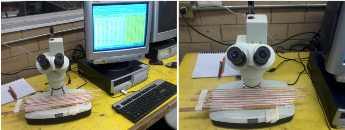
Figura 14. Observación con estereoscopio para la datación segura de los anillos de crecimiento
