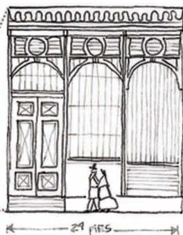
17d Sección longitudinal. Las columnas servían como bajadas de agua pluvial
