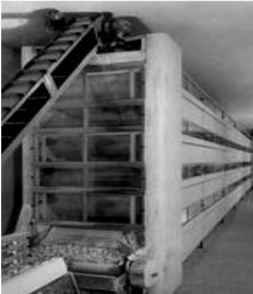
Figura 11. Máquina para secado de pastas cortas.
