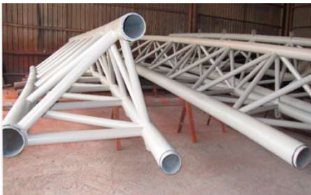
Imagen 110. Armadura de Perfil OC. Steel Construction.2013.
