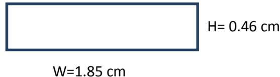
Figura 3.12. Diseño de los ataques para el sistema de colada estudiado.
