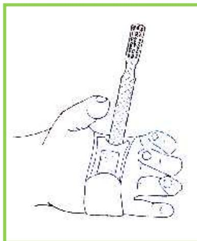
Figura 20. Correa de velcro ajustable.<sup>74</sup>
