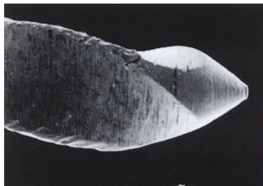
Fig. 8. Lima Flex-R de Moyco Union Broach. Microfotografía de la punta de la parte activa de la lima Flex-R (Punta Roane). 1
