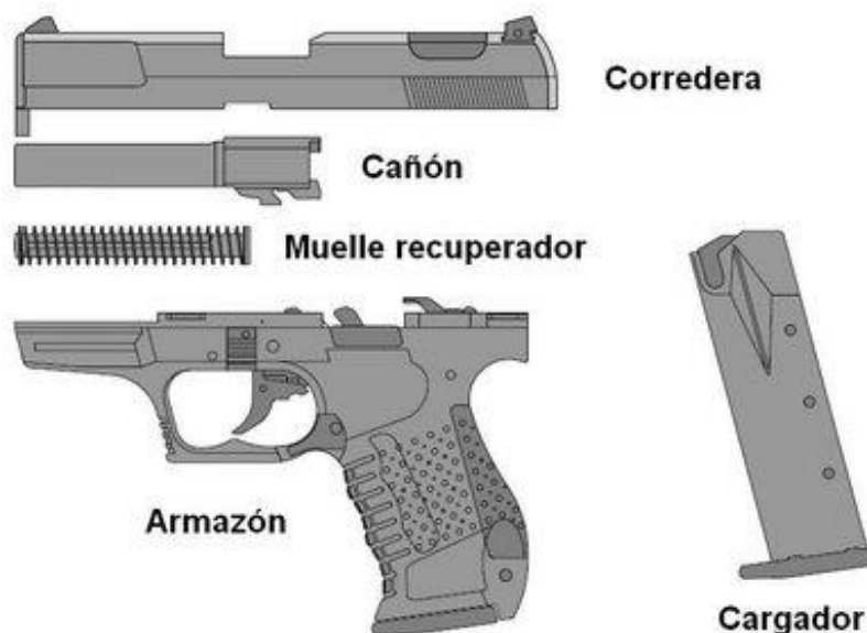
Figura 3. Pistola y sus partes
