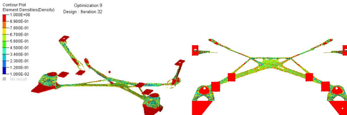
**Figura 7-10: Detalle de la topología de la optimización 9**
