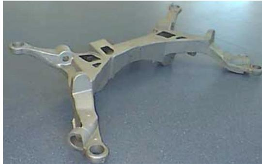
**Figura 2-19: Sub-chasis trasero fabricado en una sola pieza con tecnología VRC/PRC
