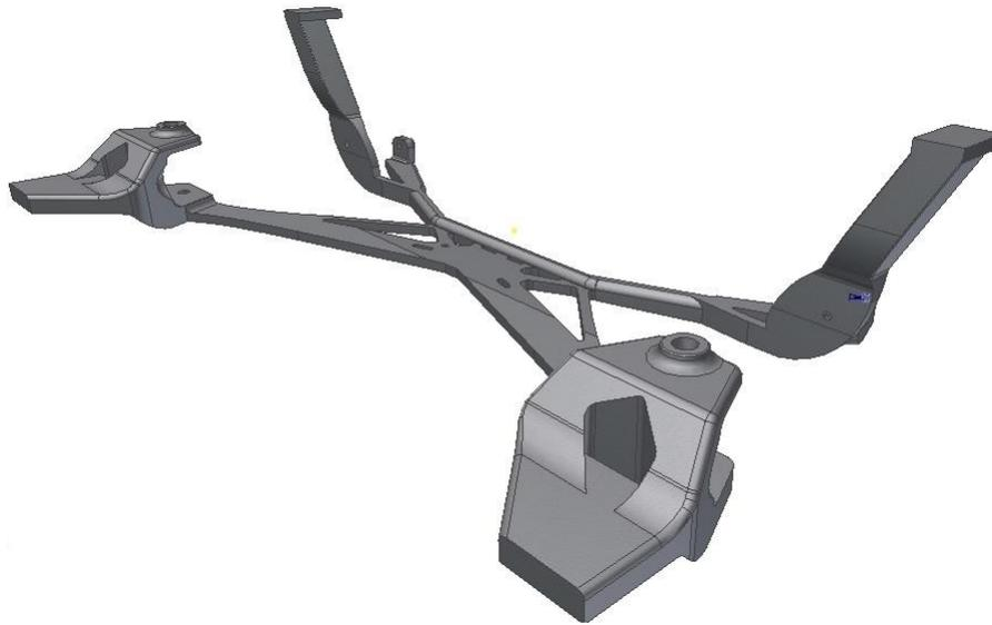
**Figura 7-28: Modelo CAD del sub-chasis**
