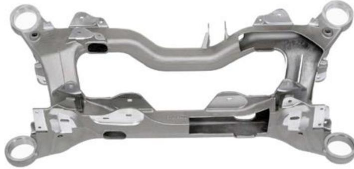
**Figura 2-21: Prototipo de sub-chasis en fundición en arena con aleación AlSi7Mg (peso final: 17.1 kg)**
